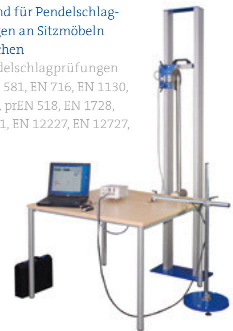
Prüfstand für Pendelschlagprüfungen
