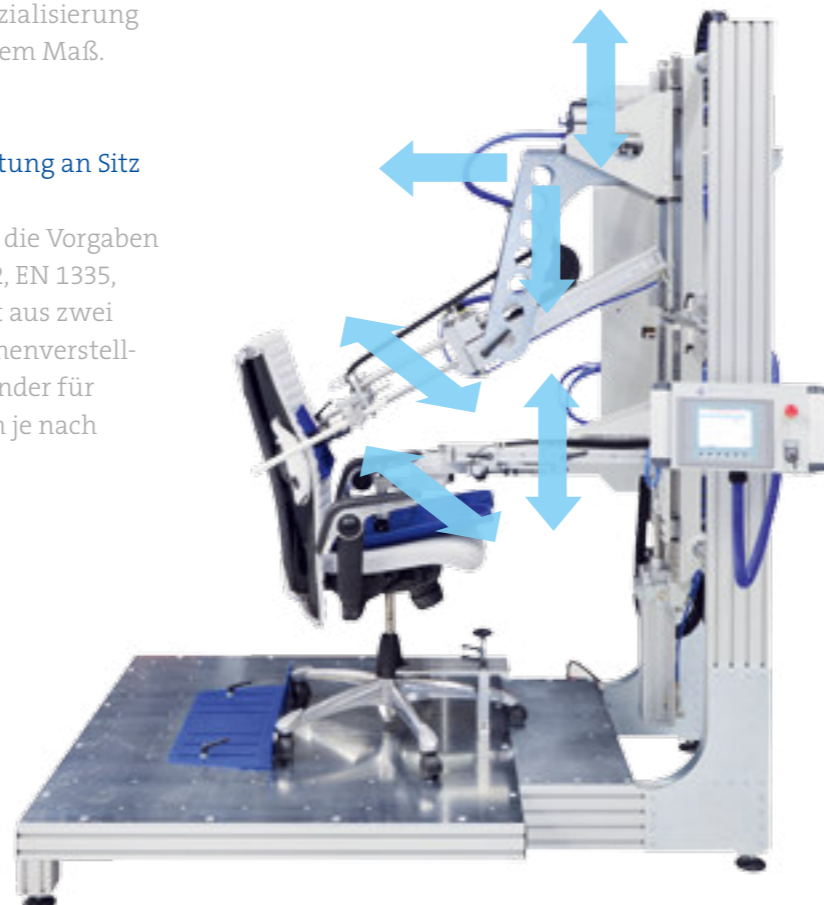
Prüfstand für Biegewechselbelastung an Sitz und Rückenlehne
