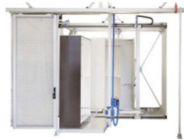
Prüfstand für Schranktüren und Schubladen
