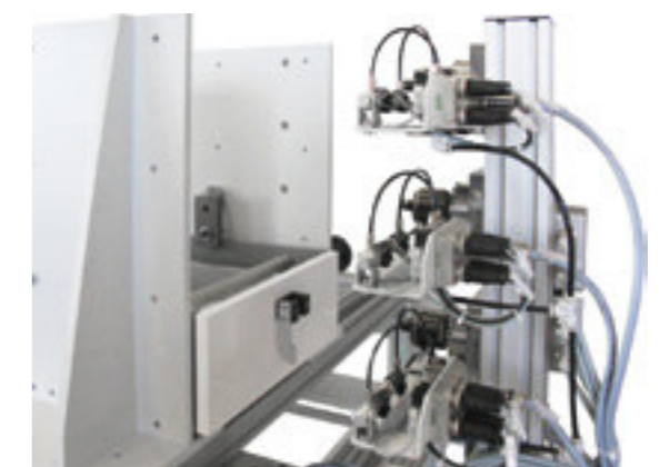
Prüfstand für maximal drei Schubladen
