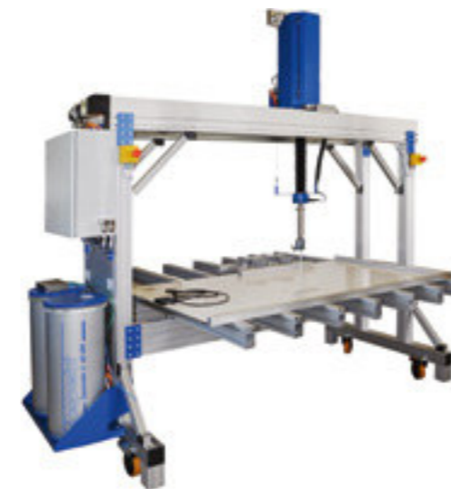
Prüfanlage für 90°-Peelversuche an Solarmodulen
