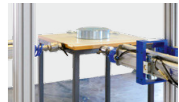
Tischprüfung im universellen Prüffeld
