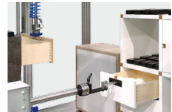
Schubladenprüfung im universellen Prüffeld
