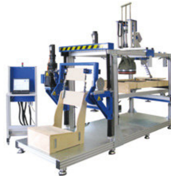
Kombinierter Prüfstand für die Positionsverstellungen von Beschlägen
