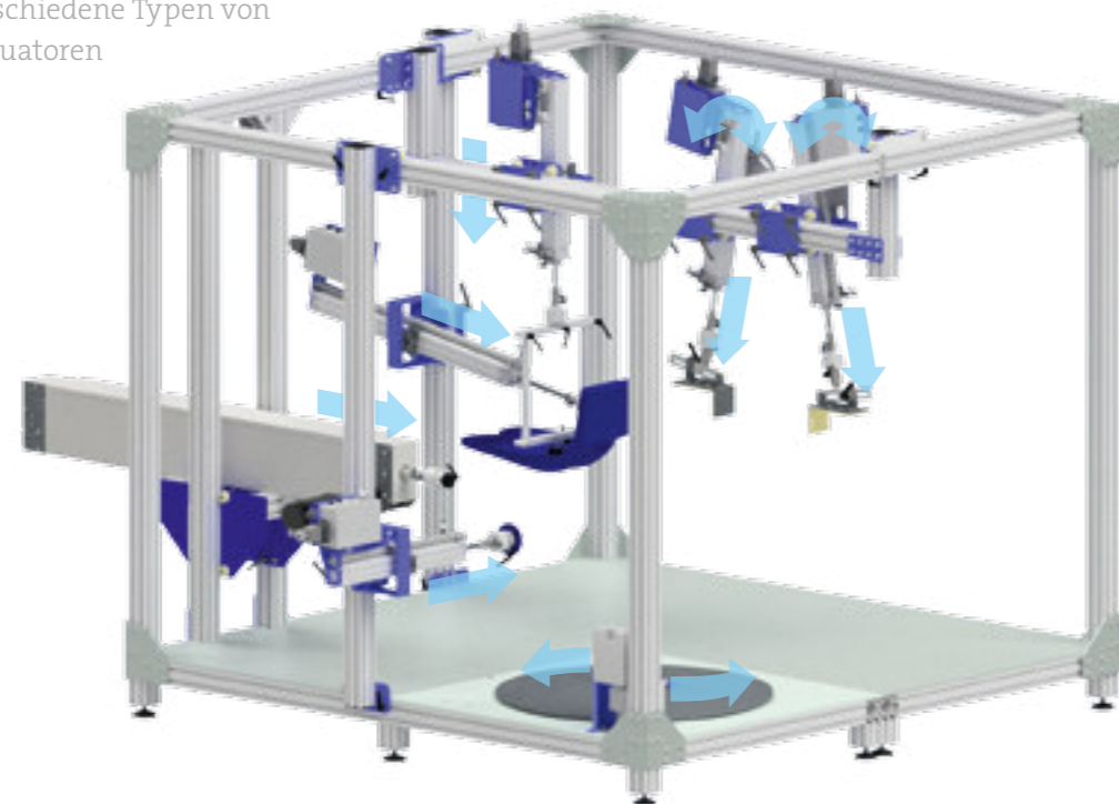
Veranschaulichung möglicher Bewegungs- und Belastungsrichtungen der Prüfachsen in einem universellen Prüffeld
